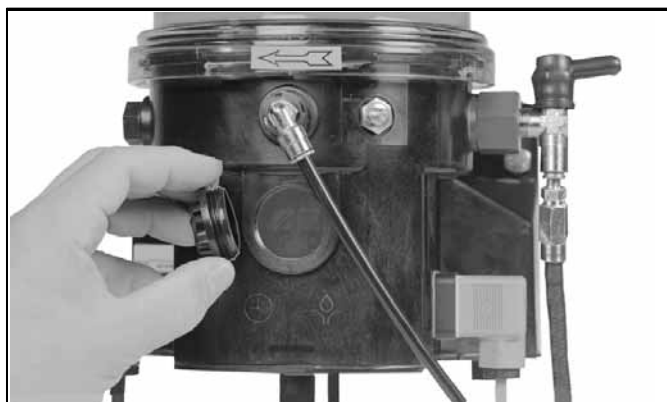
PCB 4 Tapa desmontada hacia la pletina de mando
