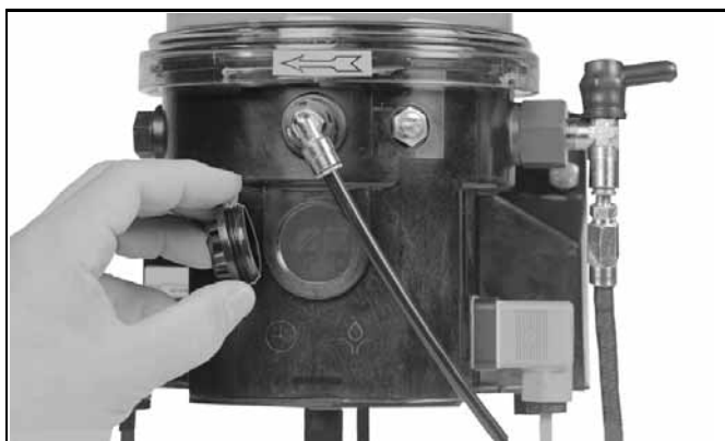
PCB 4 Verschlussdeckel zur Steuerplatine
