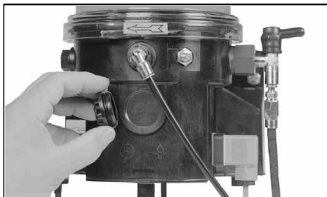
PCB 4 Coperchio della scheda elettronica rimosso
